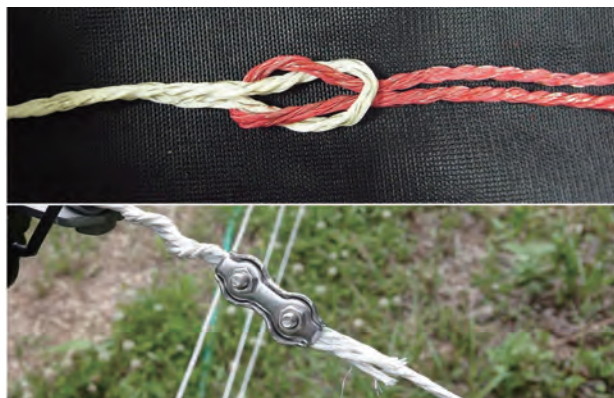
写真 78 / ポリワイヤーの結び方（本結び）とポリワイヤークラップの連結
