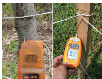
写真 70 生木・たる木も雨や夜露が染みこむと大きく漏電する
