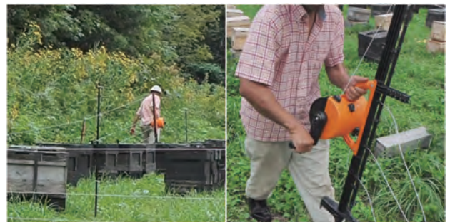
写真 68 / 4 段一度に架線、撤去が可能のため短時間、省労力で作業が行える
