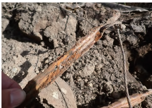
写真 41 /腐食したアース棒 錆は電気を通さないため、腐食したアース棒では回路が成立しにくい
