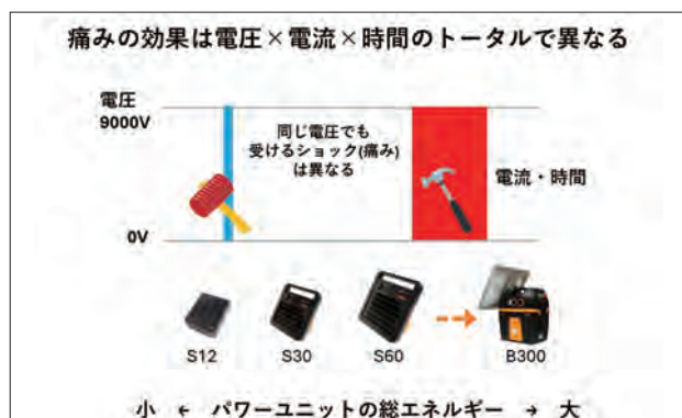
図5 / パワーユニットのクラスによるショックの違い
