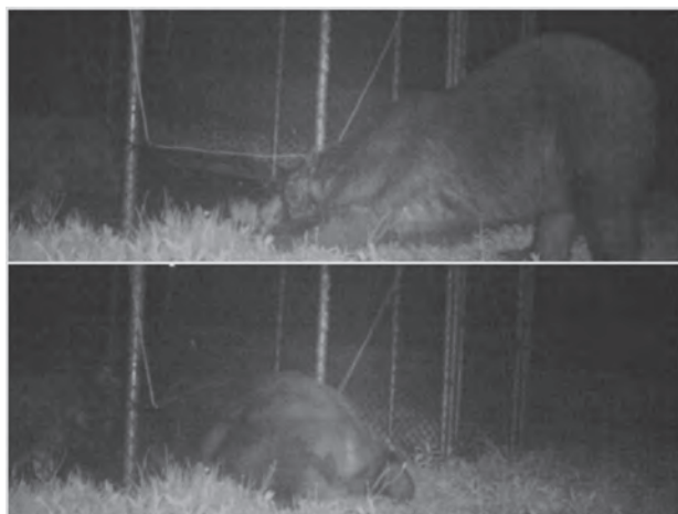
写真 56 / 電気柵ワイヤーの位置が高いと、警戒より欲求が勝り侵入を許す その後、ワイヤーの位置を下げると侵入は止まった
