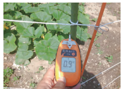
写真 71 園芸支柱（イボ竹）中に金属が使用されており気づかず漏電している恐れがある
