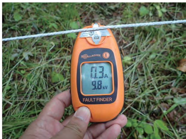
写真 36 / 電圧は最低でも 4000V 以上を維持するよう努力する
