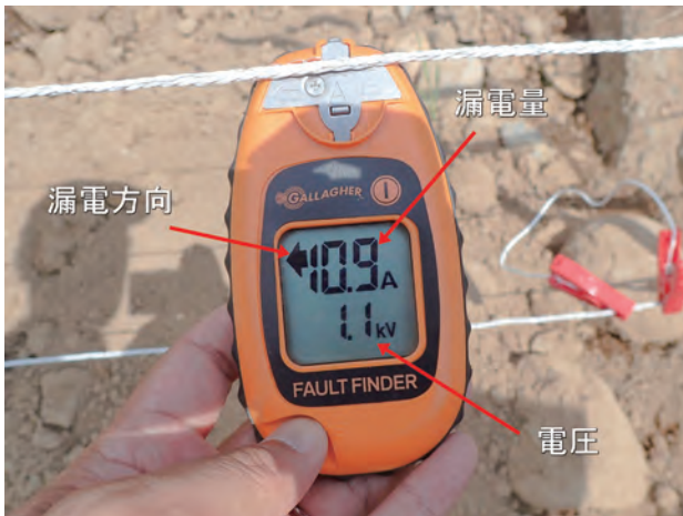
写真 75 / 電圧、漏電量、漏電方向を表示し探知するテスター
